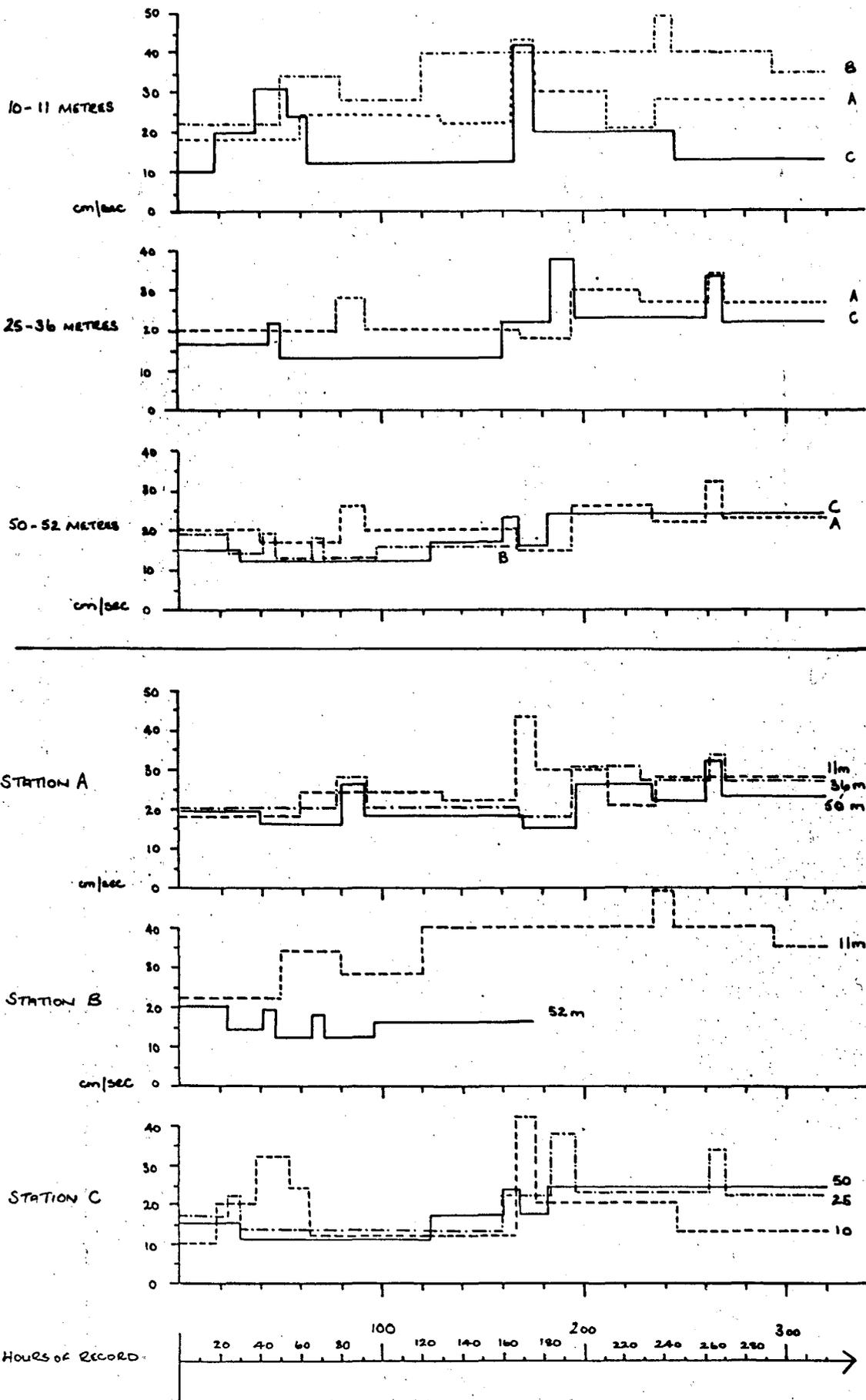
COMPARISON OF THE GENERAL LEVELS OF THE DOMINANT PEAK VELOCITY LEVELS AT EACH RECORDING LEVEL AND EACH STATION
